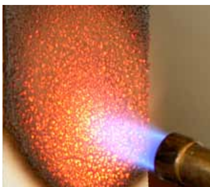
Brandwerende coating schuimt op door verhitting
