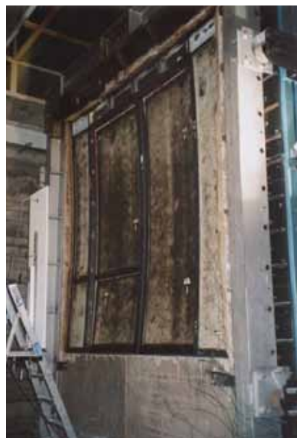
Brandproef van een schuifpui 3,2 m l hoogte met brandwerend glas (het brandwerende glas is reeds opgeschuimd).
